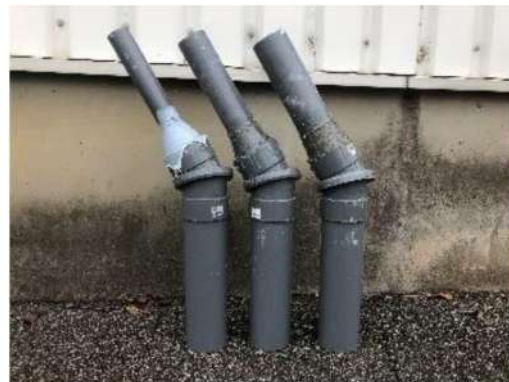
図 6 断面積の影響評価に利用した実験模型
