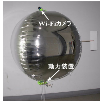
Fig.3 目視検査のための小型無人飛行船
