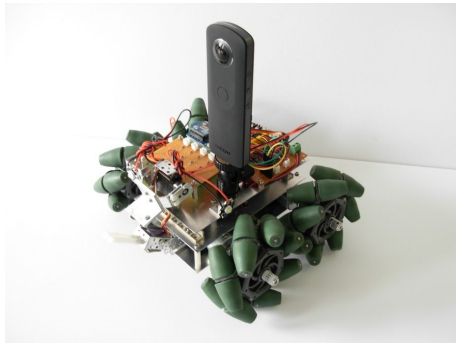
Fig.10 天球カメラを装備した検査ロボット
