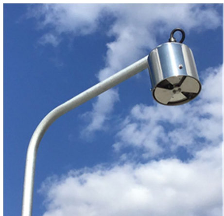
図.1 独自開発フィールドミル外観
