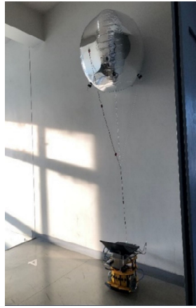
Fig.1 UGV と無人飛行船の協調による空間環境把握システム
