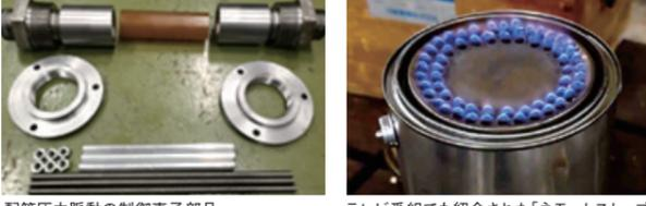
配管圧力脈動の制御素子部品
