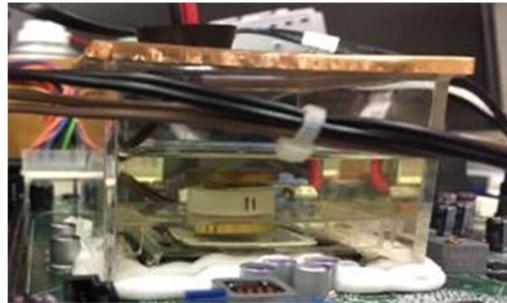
研究室で開発した液浸冷却システム
