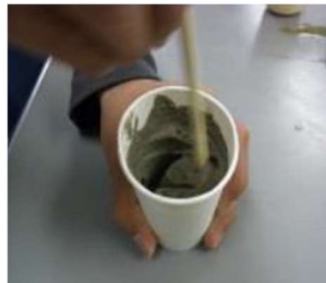
練り混ぜ (材料 : ジェットセメント、水)
