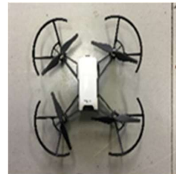
ドローン (重量 : 約 80g) 寸法 : 98×92.5×41mm
